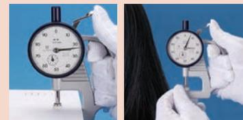
Medidores de Espessura podem facilmente medir produtos como papéis e lentes. Ponta de contato e batente feitos em cerâmica: livres de corrosão (excluído modelo 547-401A.)
