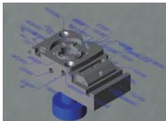
**Geração automática de programas (rotinas) de medição a partir de arquivos CAD 3D**
