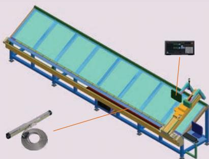
Utilizando uma escala Digimatic ABSOLUTE combinado com um sistema de posicionamento e visão com uma lupa, um sistema de medição de largura e comprimento de filmes plásticos pode ser facilmente desenvolvido.
