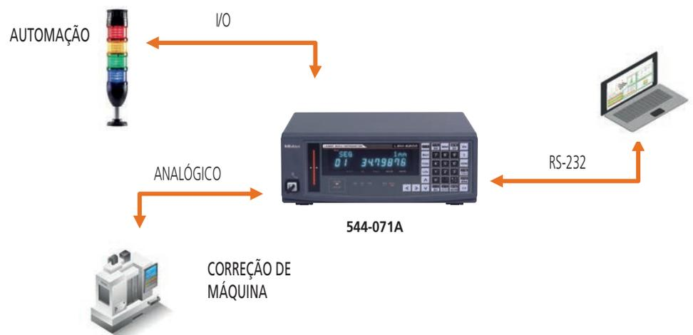
O contador utilizado com o LSM possui diversas formas de saída de dados, podendo ser incorporado em qualquer aplicação com facilidade.
