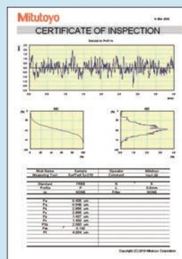
Série SJ-410 possui interface USB, permitindo configurar as condições de medição e iniciar a medição via PC que permite criar tabelas de registro de inspeção através de uma macro do Microsoft Excel.
