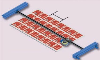
Utilizando uma escala Digimatic ABSOLUTE combinado com um sistema de posicionamento e visão com uma lupa, um sistema de medição de largura e comprimento de filmes plásticos pode ser facilmente desenvolvido.
