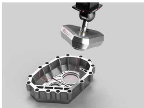
O sensor laser de medição sem contato realiza a medição em menos tempo que os sensores de medição por contato. A digitalização de uma só vez a partir de três feixes de luz que permite medir simultaneamente as faces superiores e laterais, o que requer menos mudanças de posição do cabeçote, aumentando a eficiência da medição mesmo em peças mais complexas.
