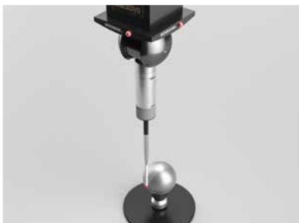
A medição das superfícies livres das próteses de articulações pode ser realizada usando um sensor de scanning compacto e de alta precisão. A análise do erro tridimensional pode ser realizada obtendo mais pontos na medição.
