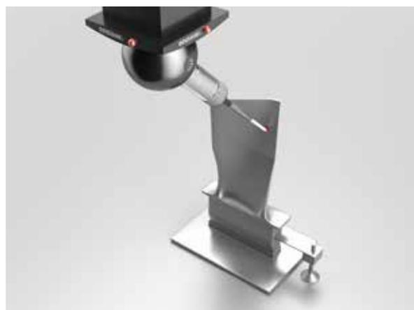
A seção transversal da hélice de uma turbina do motor de aeronaves pode ser medida com o sensor de scanning compacto de alta exatidão. Até mesmo peças que variam bastante, como peças fundidas, podem ser medidas de forma rápida e confiável
