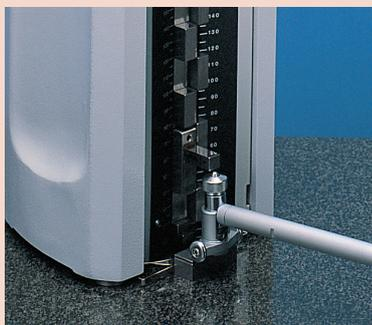
Fixação de zero em medidor interno Bore Gage
