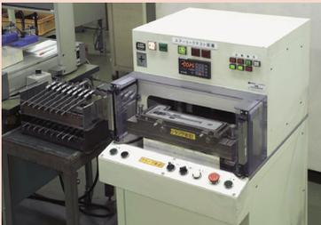
Equipamento para teste de vazamento de ar em paquímetros à prova d'água
