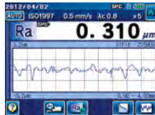
Perfil mostra: resultado da medição com parâmetro e o perfil medido
