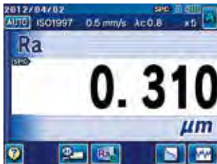
1-parameter mostra: resultado da medição com um parâmetro
